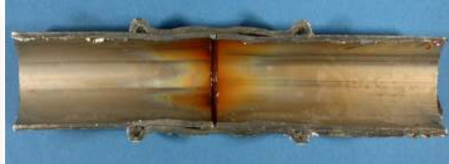
Napuknuća od korozije
